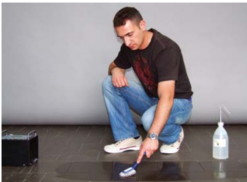
Bild 5: Verteilen des Gleitmittels auf dem Boden
